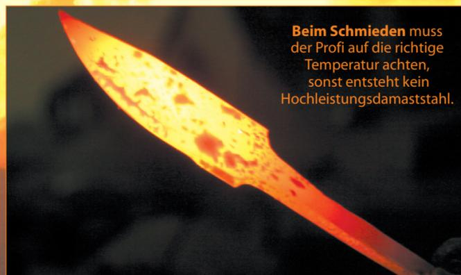
Beim Schmieden muss der Profi auf die richtige Temperatur achten, sonst entsteht kein Hochleistungsdamaststahl.
